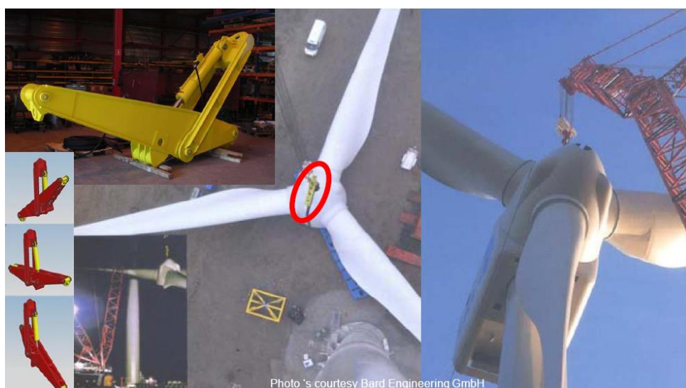
Figure 41 : Outil de basculement du rotor, de 165 t de capacité (source Gusto MSC).
