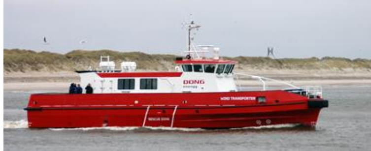
Figure 80 : Navire de transfert monocoque sur le parc éolien en mer d'Horns Rev (source DONG Energy).
