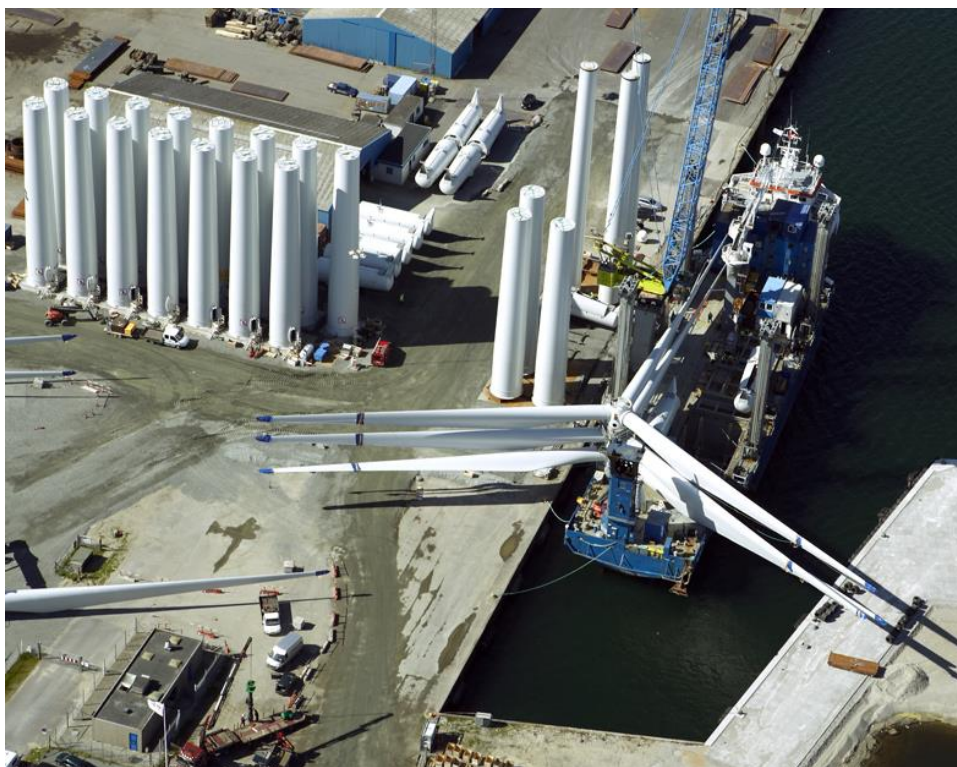
Figure 39 : Chargement d'aérogénérateurs à quai (source DONG Energy).
