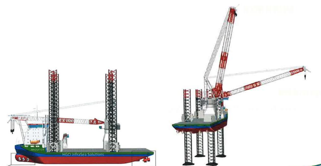
Figure 40 : Navire HGO Innovation en mode navigation et en mode élevé (source HGO).
