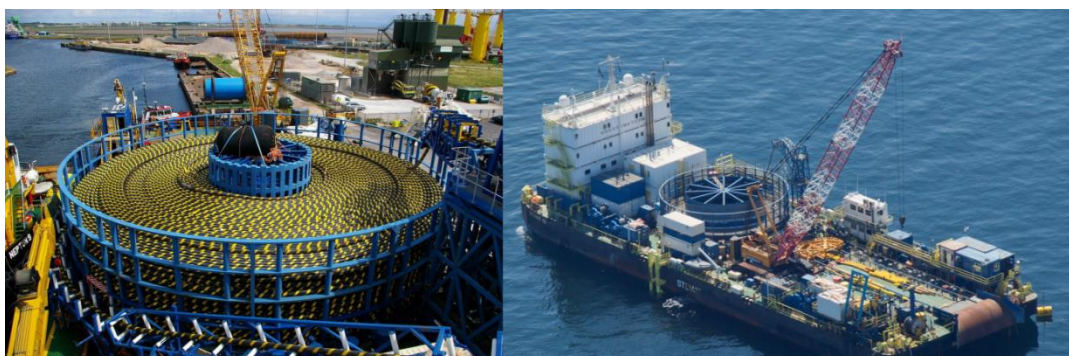
Figure 43 : Barge équipée d'un carrousel (source DONG Energy).
