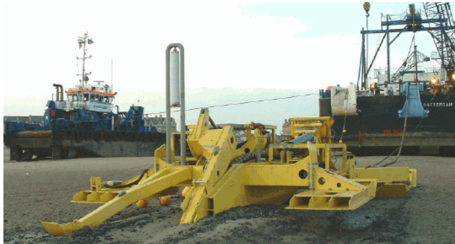
Figure 59 : Exemple de charrue (schéma de principe et photographie)
