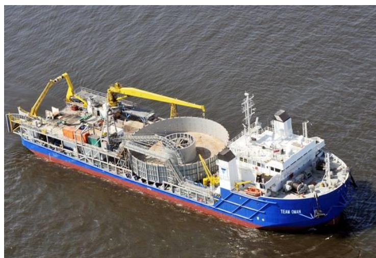
Figure 65 : Illustration d'un navire posant des câbles (Source : Global Marine System)
