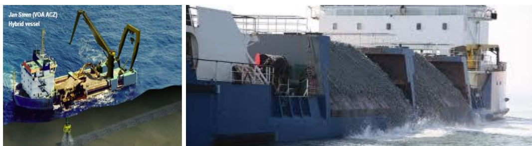
Figure 51 : Exemple de navire durant une opération de dépôt de matériaux (source DONG Energy).
